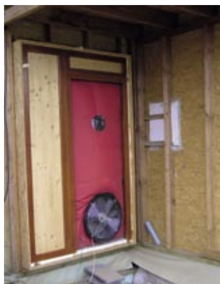
Obr. 3 Kontrola vzduchotesnosti stavby – Blower Door Test, 08/2008, Ing. Jiří Novák, PhD., Fakulta stavebná ČVUT v Prahe
