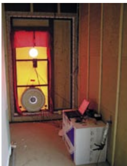
Obr. 3 Kontrola vzduchotesnosti stavby – Blower Door Test, 08/2008, Ing. Jiří Novák, PhD., Fakulta stavebná ČVUT v Prahe
